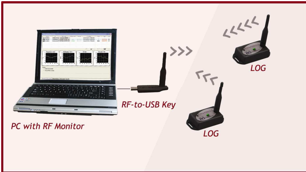
Abb. mit 4 Signalen auf PC-Schirm - 2 Funkmodulen mit je 2 int. Sensoren
